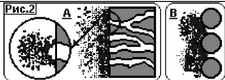
Рис. 2 Пример отличия ФЭП от пористых фильтрующих материалов
